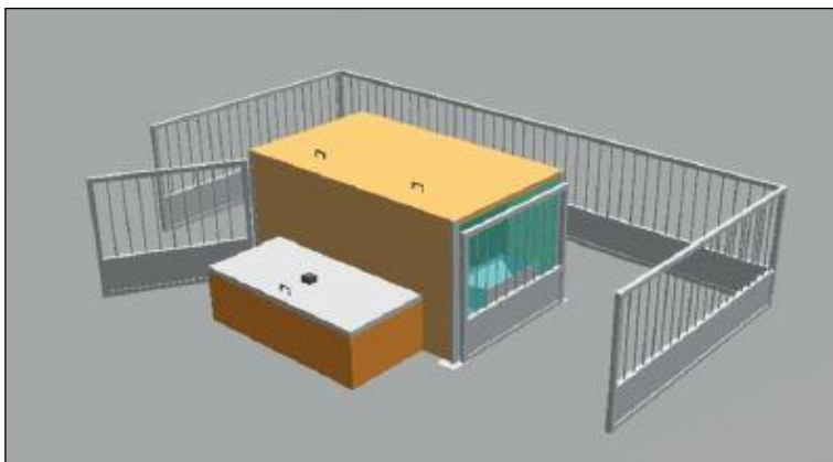
Рис. 4. Спеціальні двері термобоксу для утримання свиноматки
