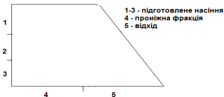
Рис. 2. Схема відбирання насіння на пневмостолі
