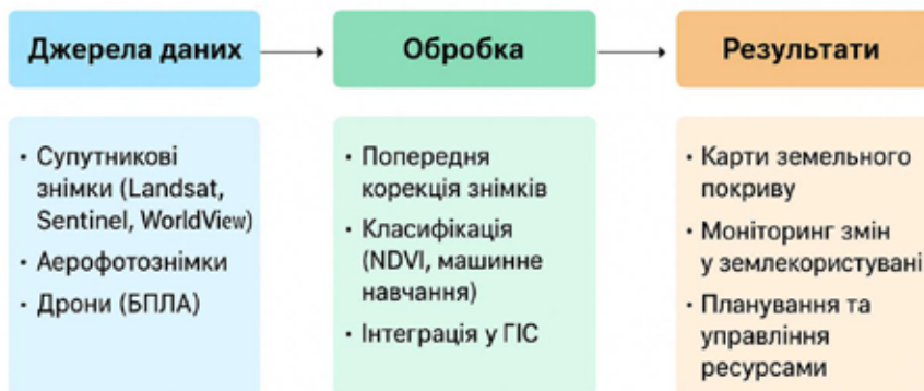
Рис. 1. Етапів картографування земельного покриття на основі ДЗЗ
